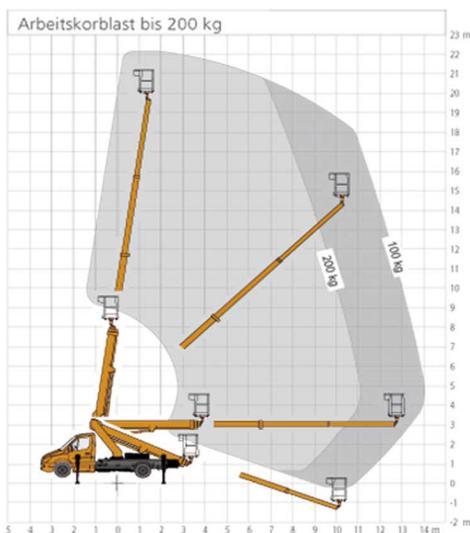
und Zufahrten sind möglich, denn Sie können den STEIGER® jeder Einsatzsituation angepasst abstützen. Natürlich werden je Abstützposition vollautomatisch entsprechende Leistungsdaten von der Gerätesteuerung zugewiesen.
